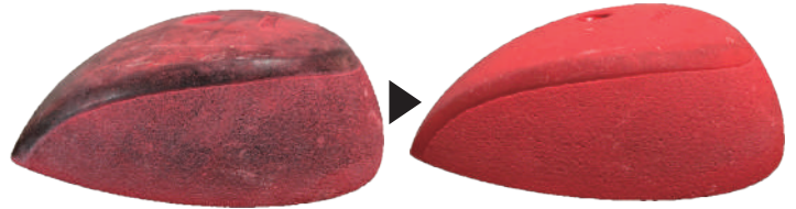
側面、ざらざら面に付着したゴム跡
